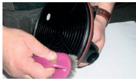
6. Очищаем мягкой щеткой рабочую поверхность присоски.
