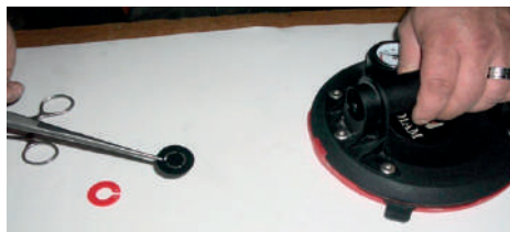
3. Вынимаем прокладку (арт. 6815011), протираем силиконовым спреем.
