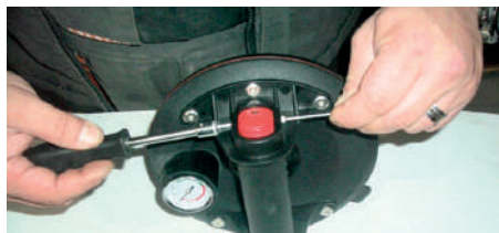
4. Откручиваем гайку (арт. 9011322) и вынимаем винт (арт. 6815010) фиксирующий кнопку сброса давления (арт. 6815007), протираем силиконовым спреем заглушку кнопки сброса давления (арт. 6815008).
